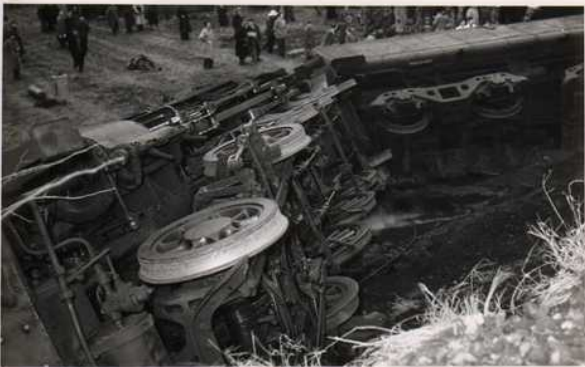
Die entgleiste Schnellzug-Dampflokomotive der SNCB
